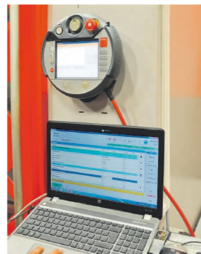
Omdat de speciale legeringen aparte parameterinstellingen vereist, gebruikt het Zonhovens bedrijf ByVision software van Bystronic voor het aanpassen van de snijparameters.
