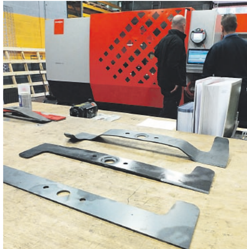
Dalemans Industries snijdt onder andere deze grasmaaiermessen uit een speciaal mangaanvanadiumstaal. Daarna worden de snijkanten gefreesd, dan wordt het mes warm gevormd en daarna gehard.
